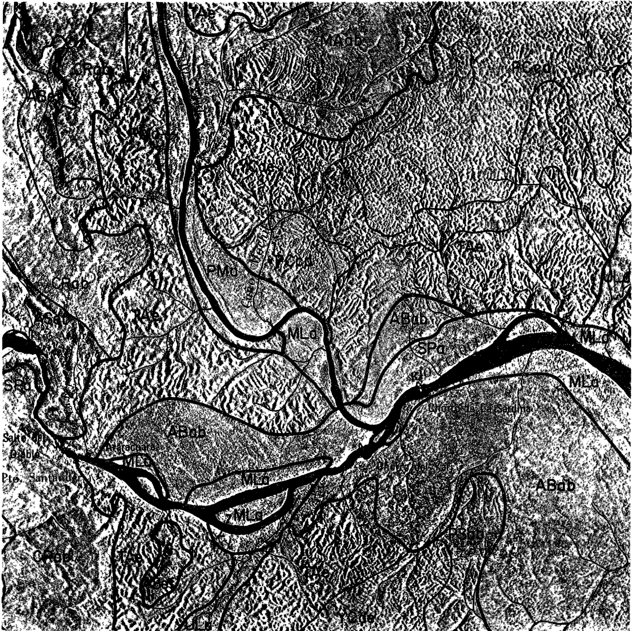
Interpretación de unidades de suelos en mosaico semicontrolado de radar a escala 1 200 000 de Aracuaera y sectores aledaños, (Intendencia del Caquetá y Comisaría del Amazonas)
