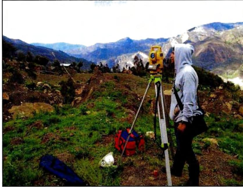
El proceso de edición se realizó descargando toda la información colectada a un computador, con lo que se genera la nube de puntos donde aparecen todos los datos para crear la planta general, triangulación para la elaboración de curvas de nivel, perfiles y demás.
