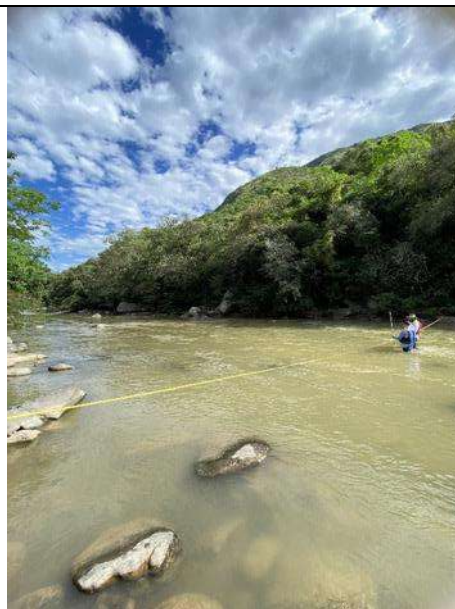
Aforo en el Río Aipe antes de la captación del canal San Cayetano
