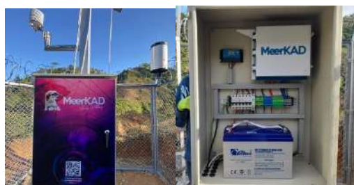
Ilustración 9: Vista Interior Datalogger MeerkAD, Sistema de Protección Eléctrica y Batería
