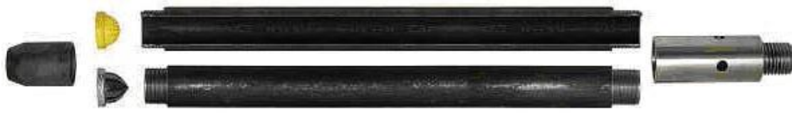
Figura 2. Muestreador estándar o cuchara partida para el ensayo SPT
