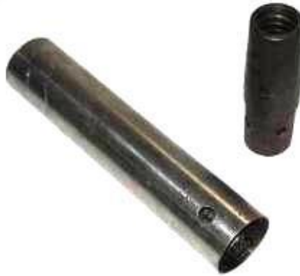
Figura 3. Muestreador de pared delgada (Shelby) utilizado para muestras inalteradas.
