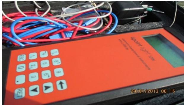
Figura 106. Equipo de Tomografías Eléctricas LGM 4point light 10W.
