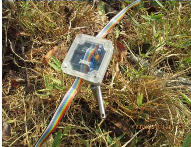
Figura 107. Sensor multi-electrodo LGM para tomografías eléctricas.
