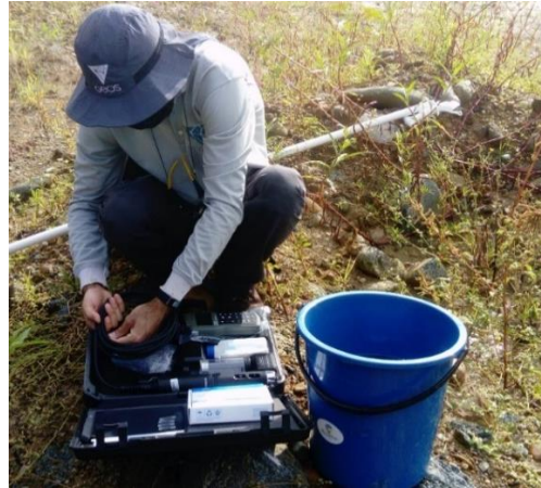
Figura 202. Equipo multiparamétrico utilizado para la medición de los parámetros en campo.
