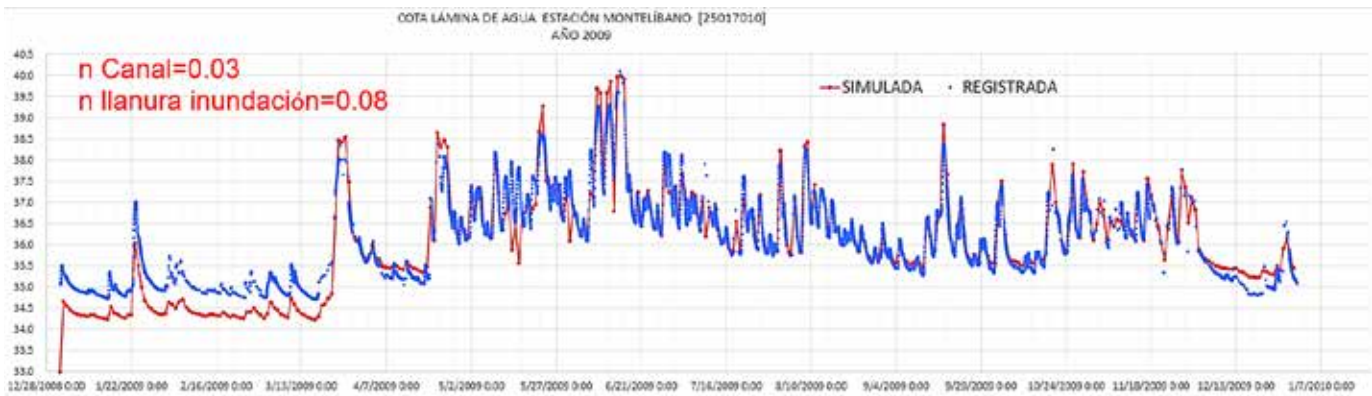
Figura 17. Estimación inicial del n de Manning a partir del resumen de aforos líquidos (arriba). Calibración hidrométrica del modelo hidráulico (abajo).
