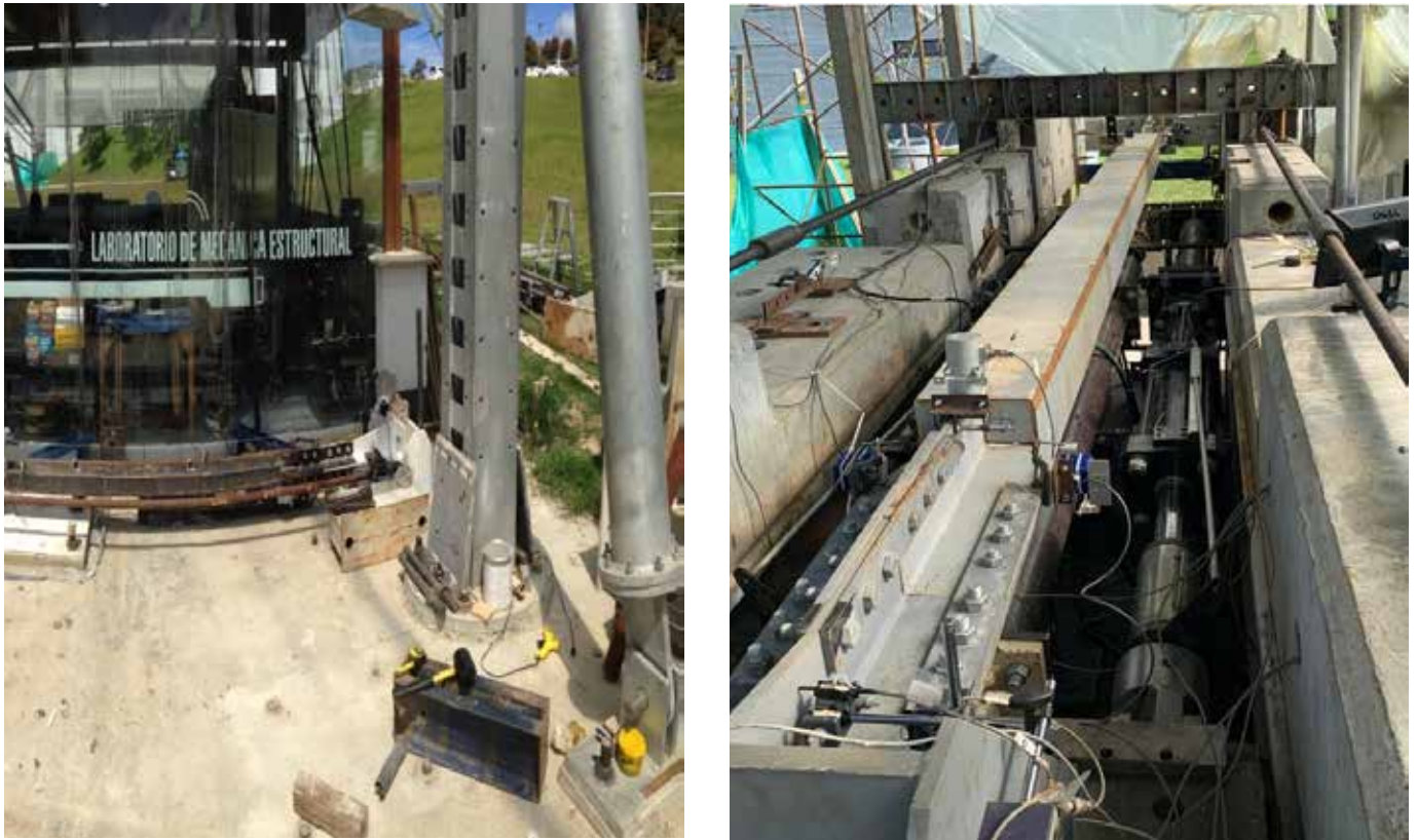
Figura 4. Primer ensayo en Colombia de prototipos de Riostra efe-Prima-ce -BRB- Universidad EIA.Superior: Proyecto Fase III. Inferior: Proyecto Fase IV.
