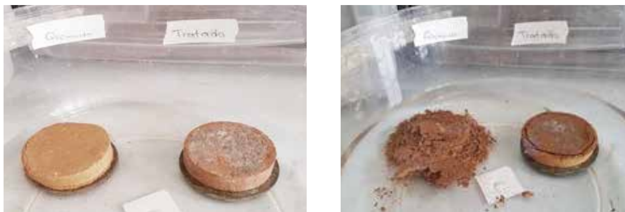
Figura 10. Ensayo de desagregación en muestra de suelo quemado y quemado-tratado: tiempo cero (izquierda), después de 24 horas sumergidas en agua (derecha).
