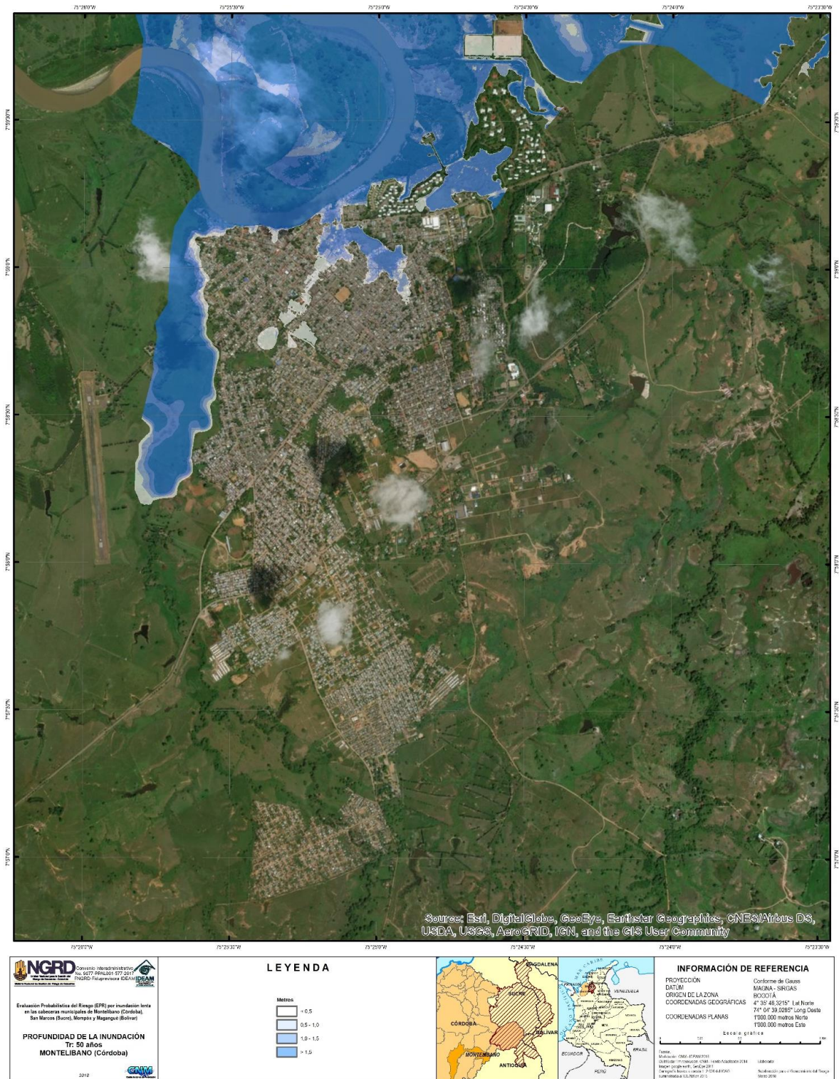
Mapa 9. Tirante hídrico de la zona inundable, para un periodo de retorno de 50 años en el municipio de Montelíbano (Córdoba)
