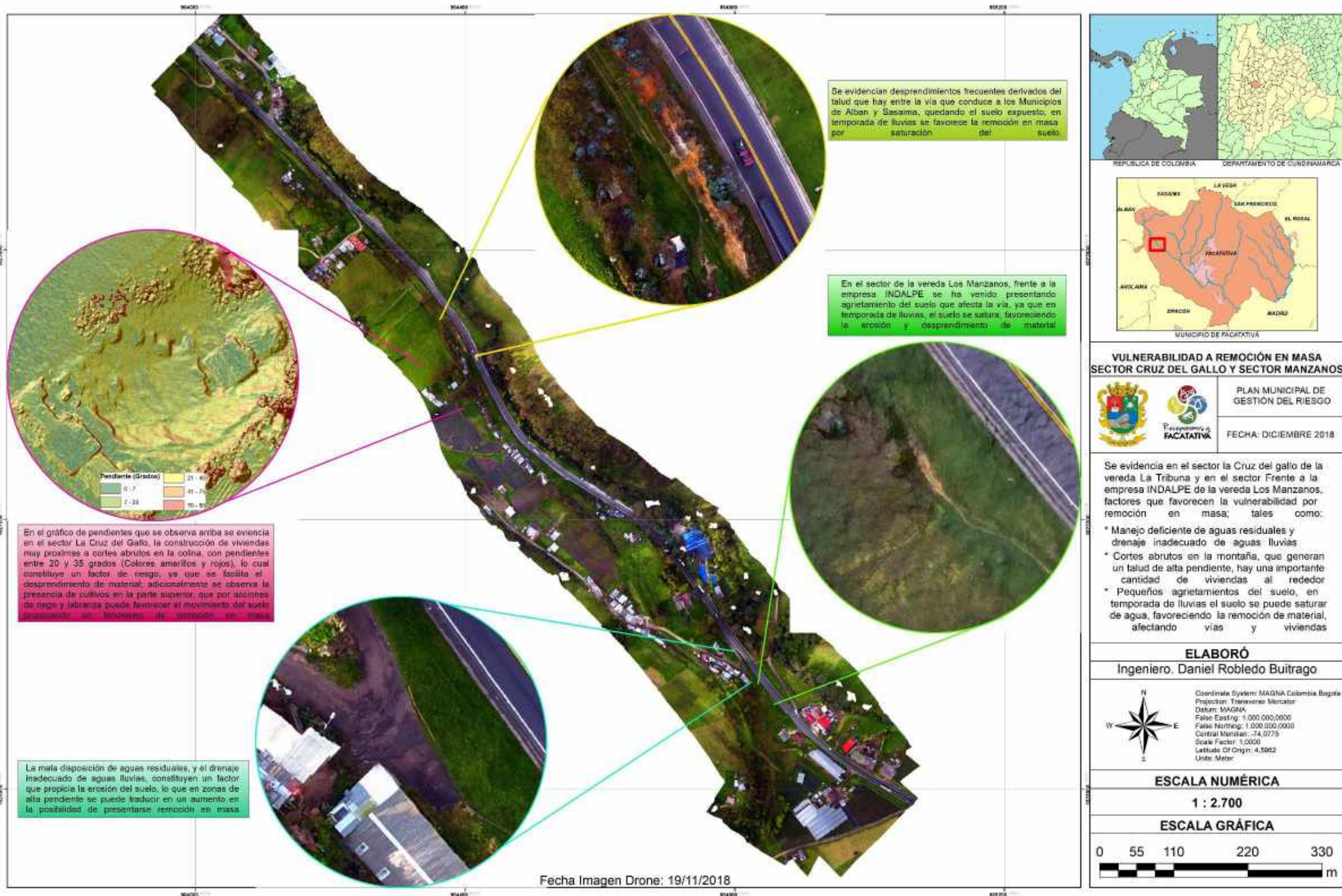
Figura. 14. Vulnerabilidad a remoción en masa Sector La Cruz del Gallo y Sector Indalpe Vereda manzanos. Fuente: Vuelo
