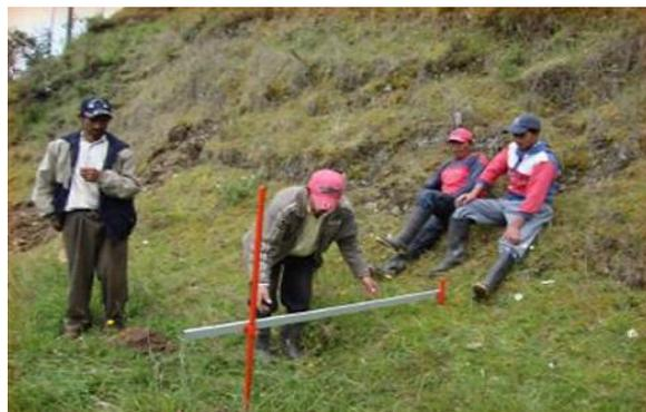
**Figura 7. Extensómetro artesanal, fuente: UNGRD (2013).**
