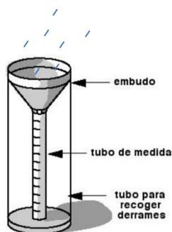
Figura 5. pluviómetro, fuente: <https://pluviometro.top/>
