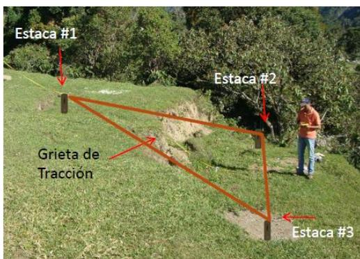
**Figura 8. Estacas topográficas artesanales, UNGRD (2013).**
