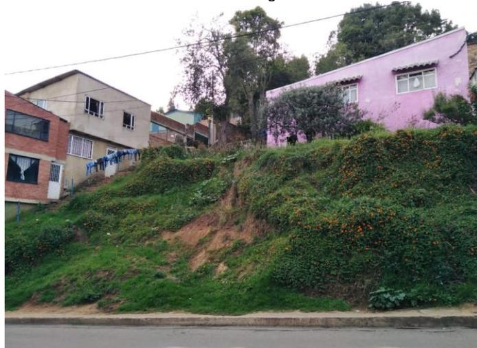
**Fotografía 24. Movimiento en masa posiblemente de tipo deslizamiento. (Barrio San Juanito).**
