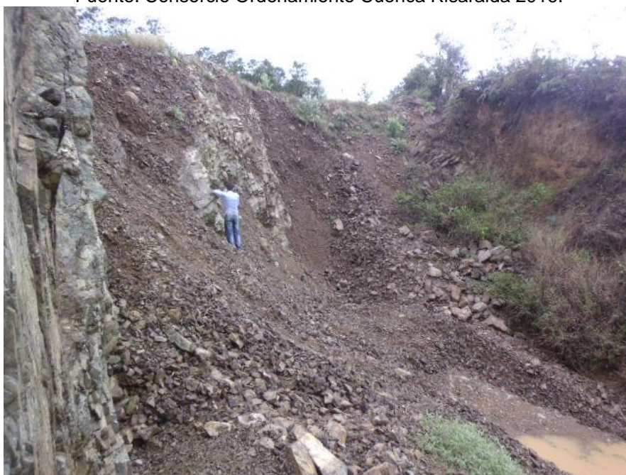
Figura 23 Cantera ubicada sobre la vía San José – Risaralda. Nótese el flujo de detritos que forma depósitos tipo talus.
