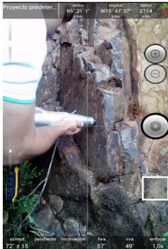
Figura 23 Medición de la resistencia de la matriz rocosa con el martillo Schmidt
