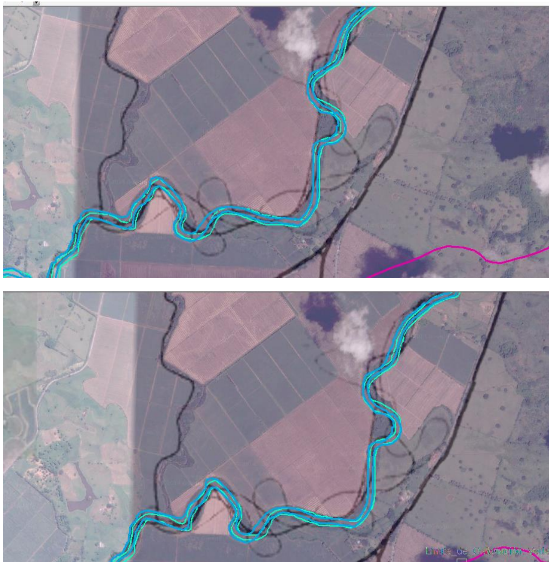
Figura 81 Análisis multitemporal en fotografías aéreas donde en líneas negras se visualizan las direcciones de cauce desde el año 1.961 hasta el año 1.994 y en azules el cauce actual y punteado el cauce de la cartografía IGAC año 1978.
