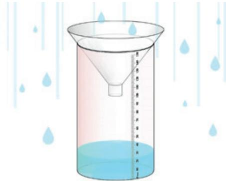
Figura 35. Pluviómetro, fuente: <https://pluviometro.top/imagenes/>
