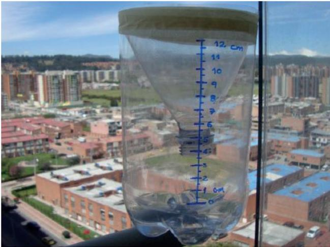
Figura 34. Pluviómetro artesanal, fuente: UNGRD, (2020).
