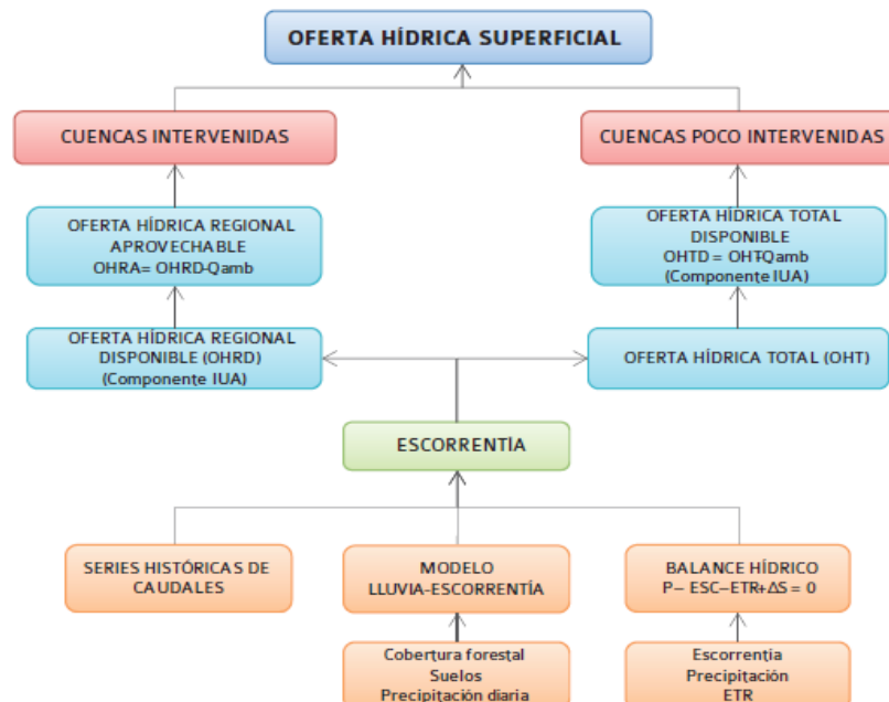
Figura 238. Procedimiento para la evaluación de la oferta hídrica superficial en las regiones.
