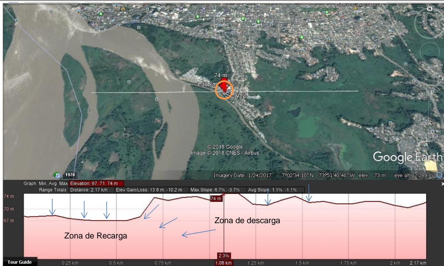
Figura 4. Corte topográfico SEV-2
