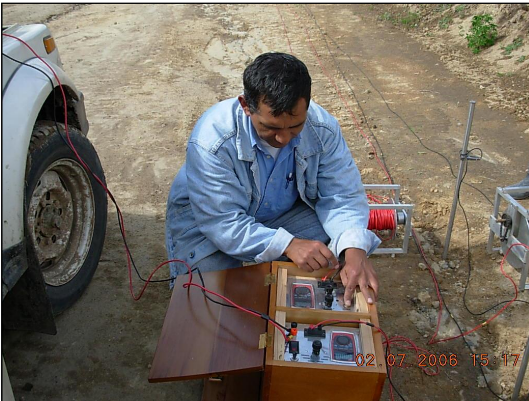
FOTO NO. 1 Muestra el equipo Hidrosystem, con el cual se realiza los estudios geoelectricos.
