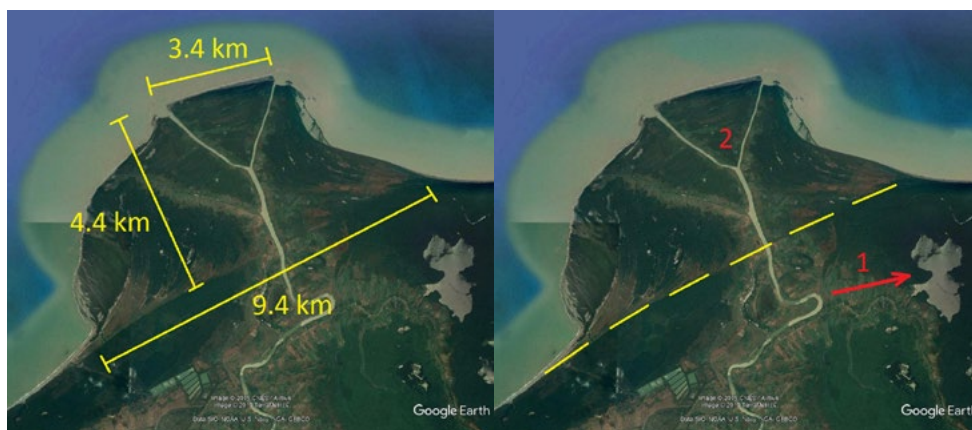
Figura 8. Delta del río Sinú en acreción. Fuente: Google Earth, 2019. Izquierda: Dimensiones del delta crecido desde el año 1938. Derecha: Dirección del cauce antiguo (1) según [18] y el brazo de Tinajones (2); la línea amarilla está trazada por el contorno visible en la figura izquierda de cambios fisiográficos y de vegetación.
