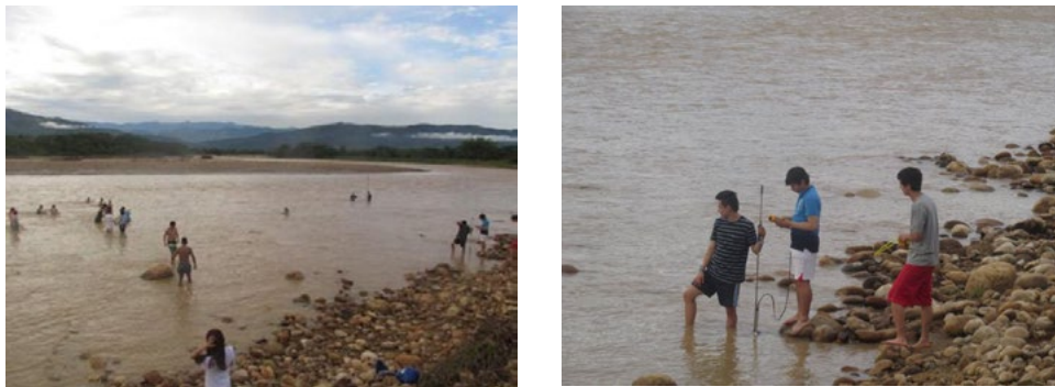
Figura 5. Aforo líquido del río Unete realizado el 04-11-2017.
