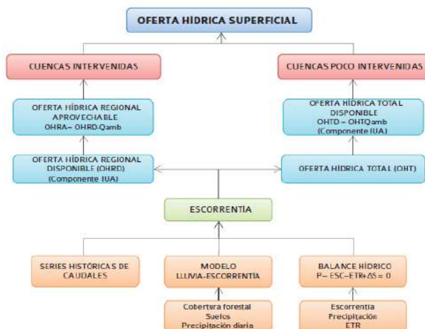
Figura 294 Procedimiento para la evaluación de la oferta hídrica superficial en las regiones.
