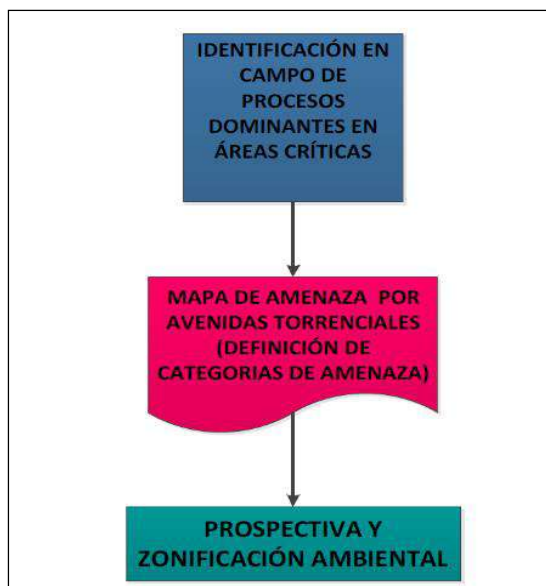
Figura 1052. Diagrama de flujo para la evaluación de la amenaza por avenidas torrenciales en áreas críticas
