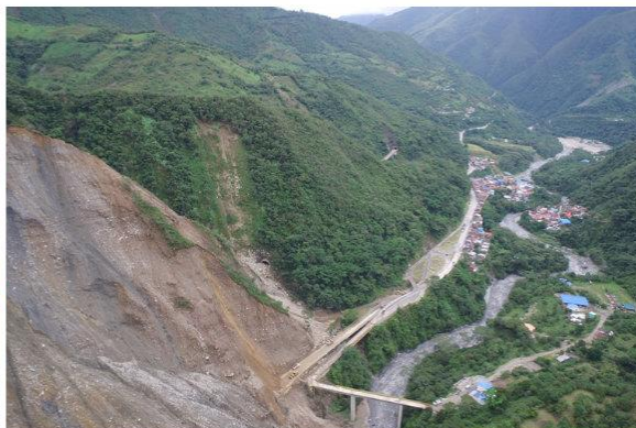
Movimiento en masa mixto: deslizamiento traslacional y flujo de lodos, Manizales (Caldas). Fuente: UNGRD
