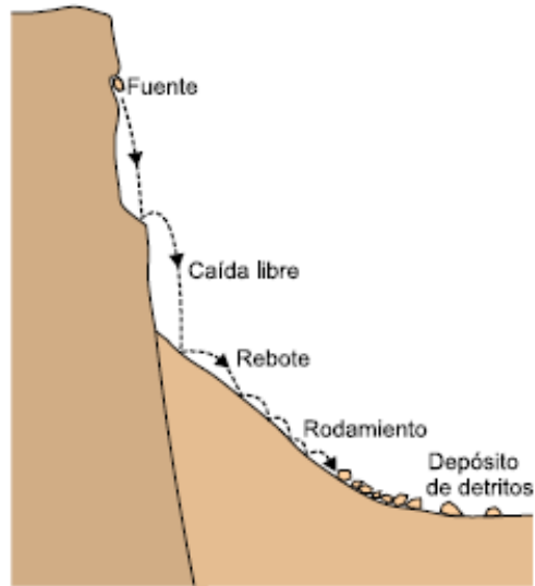
Esquema de caída de rocas. Tomada de (Proyecto Multinacional Andino: Geociencias para las Comunidades Andinas, 2007).
