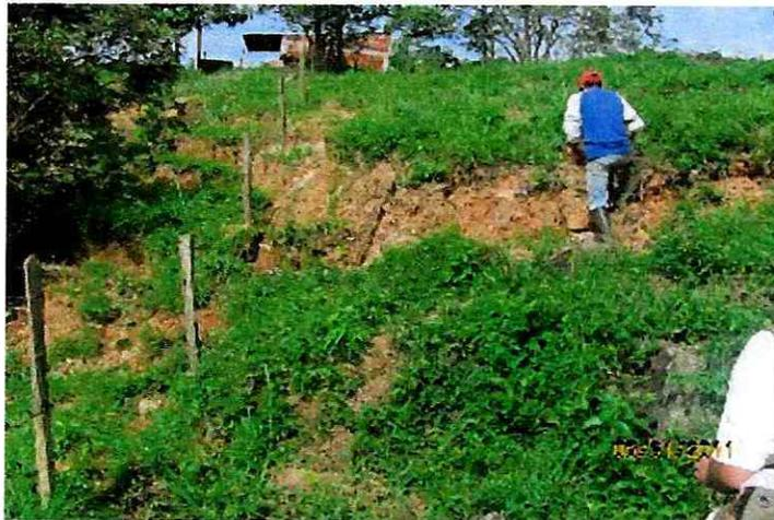
Coronas múltiples se manifiestan dentro de la masa que se desliza pendiente a bajo, esto demarca lo complejo del movimiento, este tipo de fenómenos se debe controlar y monitorear con base medidas que permitan determinar la dinámica y la dirección de desplazamiento.
