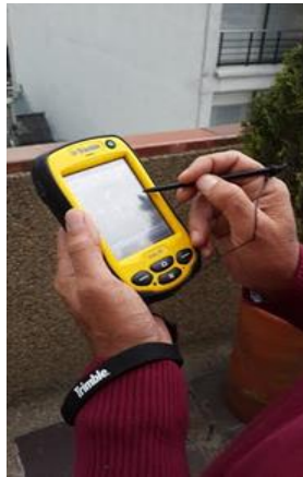
Figura 7.3 Equipo GPS Juno Trimble 3B, con capacidad de almacenamiento de diccionario de datos
