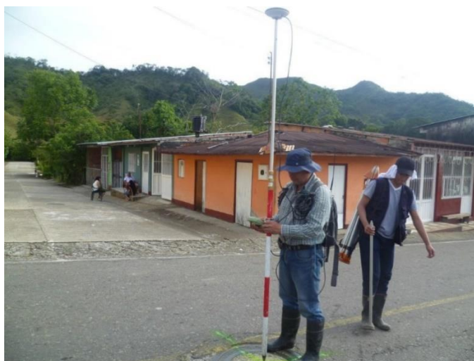
Fotografía 19. Toma de información con antena móvil GPS – RTK.
