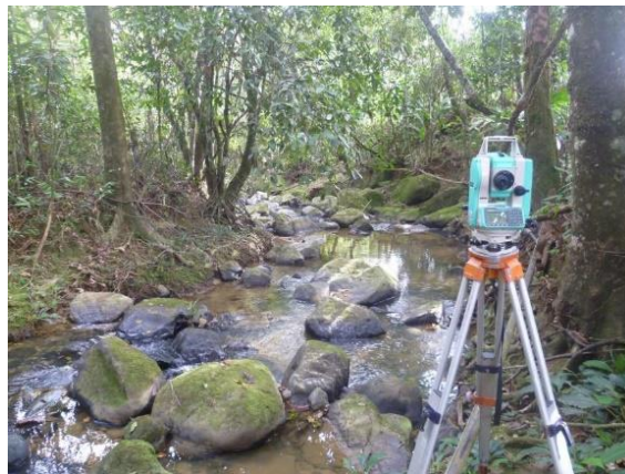
Fotografía 21. Quebrada Gazajujo. Levantamiento con estación NIKON Fuente: PI Planificación Integral Consultores S.A.S 2017.
