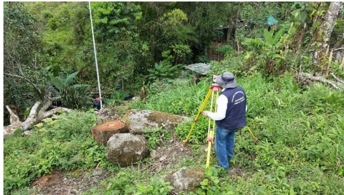
Fotografía 24. Niveles de secciones transversales con nivel de precisión Fuente: PI Planificación Integral Consultores S.A.S 2017.
