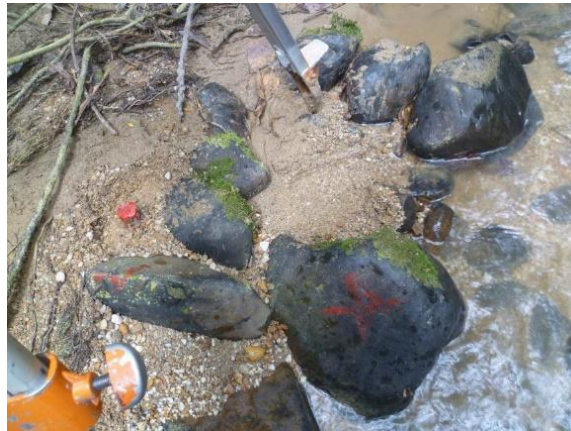
Fotografía 23. Detalla o punto transitorio para posicionar estación total Nikon Fuente: PI Planificación Integral Consultores S.A.S 2017.
