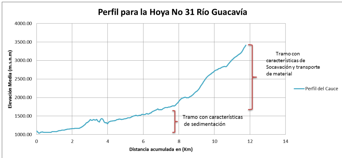
Ilustración 179 Perfil Longitudinal Hoya No. 31 – Río Guacavía
