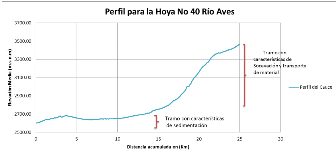
Ilustración 188 Perfil Longitudinal Hoya No. 40 – Río Aves
