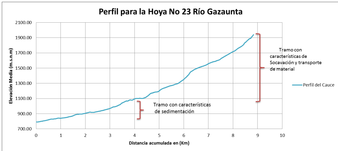
Ilustración 171 Perfil Longitudinal Hoya No. 23 – Río Gazaunta
