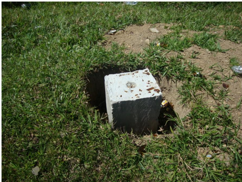
Foto 11. Aspecto general de un mojón en concreto instalado por una comisión de topografía convencional. Fuente: Construcción propia
