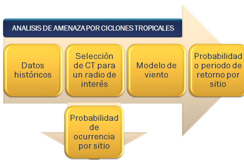
Figura 8: Esquema metodológico propuesto para la evaluación de la amenaza por ciclones tropicales. Fuente: Elaboración Propia.
