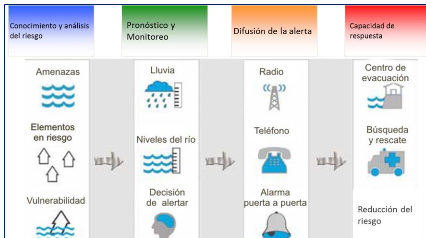
Figura 41. Esquema componentes de un Sistema de Alerta Temprana. Fuente: UNGRD, 2017
