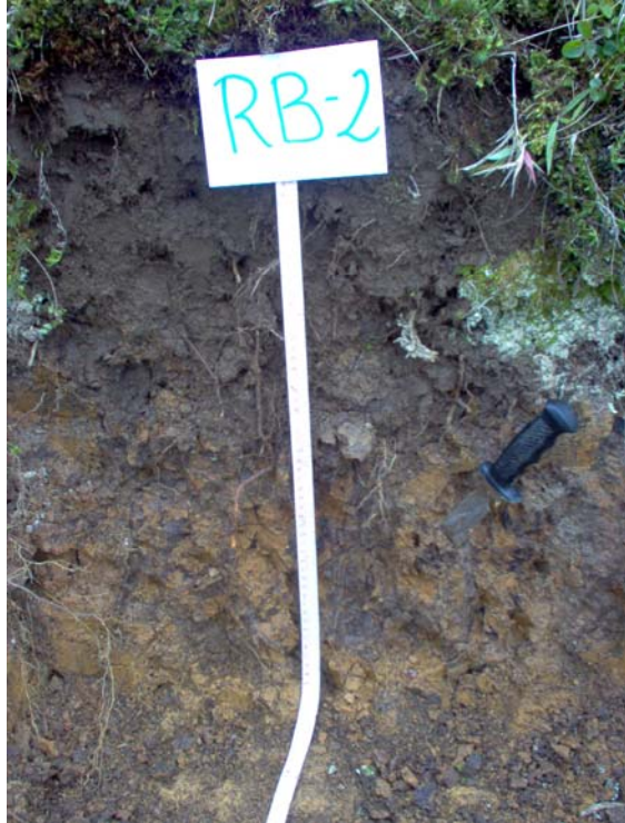
Foto 6.1.8.1/13. Perfil de suelo característico en la zona seca. Humic Dystrudepts- familia franca fina- mezclada- isomésica
