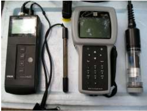
Equipos de medición de parámetros in situ, Sonda Multiparamétrica y PH metro y recipientes de muestreo para análisis de calidad de agua y muestra de sedimentos.
