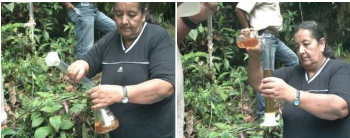
Figura 10. Análisis en campo del DBO5 en la parte alta de la quebrada mediante la aplicación de reactivos
