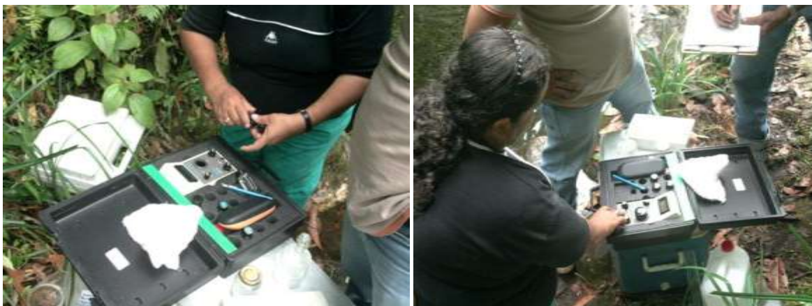
Figura 11. Análisis de la turbiedad del agua en la parte alta de la quebrada mediante el uso del turbilímetro
