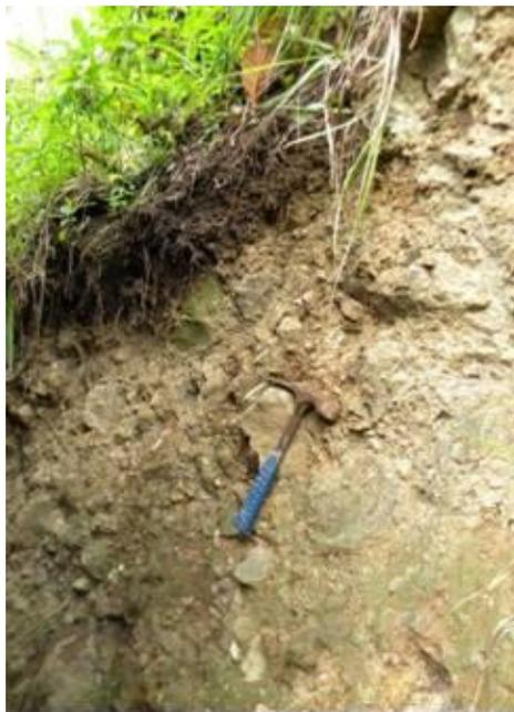
**Figura 3-10.** Depósito del Abanico del Barrio Guerra Serna, se observa estructura caótica y descomposición de los guijarros. Longitud del martillo, 28 cm.
