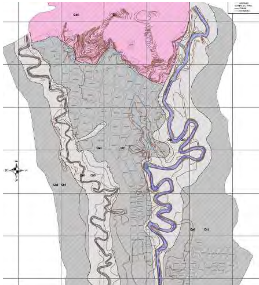
Figura 5- 1 Geomorfología local, con T0 como zona de amenaza alta por inundación.
