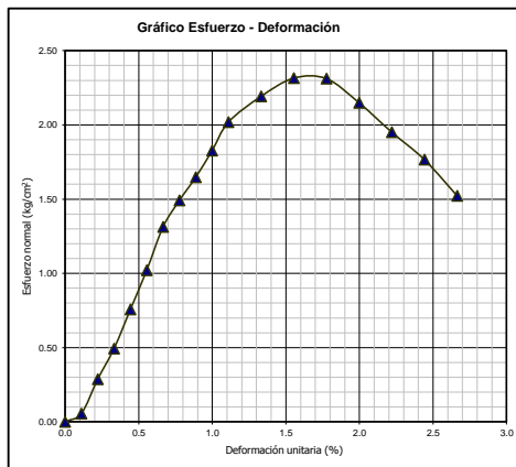
DIAGRAMA DE LA MUESTRA FALLADA
