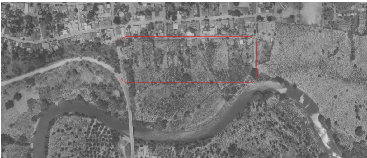
Figura 3- 9 Escarpes erosivos observados en fotografía aérea
