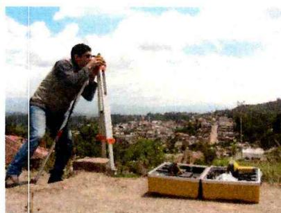
a) Instalación del receptor base GNSS-GR-5
