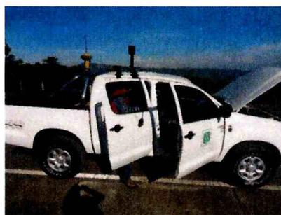
b) Instalación del sistema de cámaras Ladybug y el receptor rover
