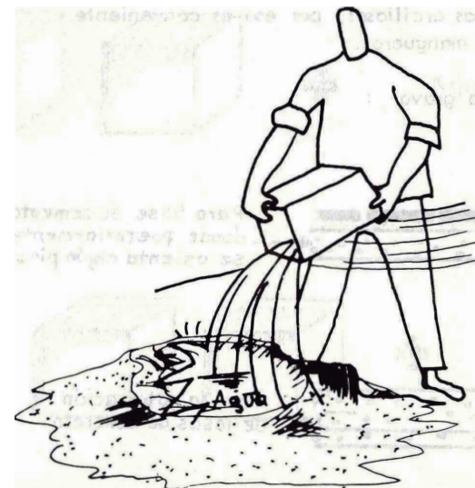
Obrero mojando el concreto.
