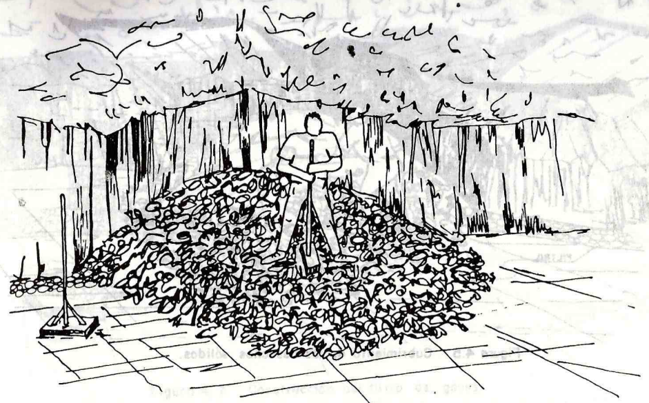
Figura 4.3 Compactación de los desechos con el pisón de mano.
