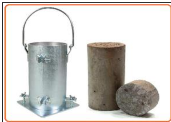
Fotografía 2-14 Cilindros de concreto
