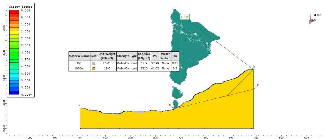
Figura 2. Distribución de los FS para el escenario actual en la condición extrema del Perfil B.
