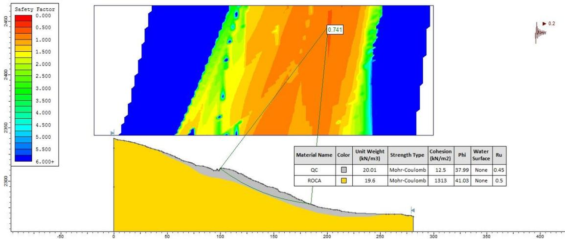
Figura 4. Distribución de los FS para el escenario actual en la condición extrema del Perfil B.
