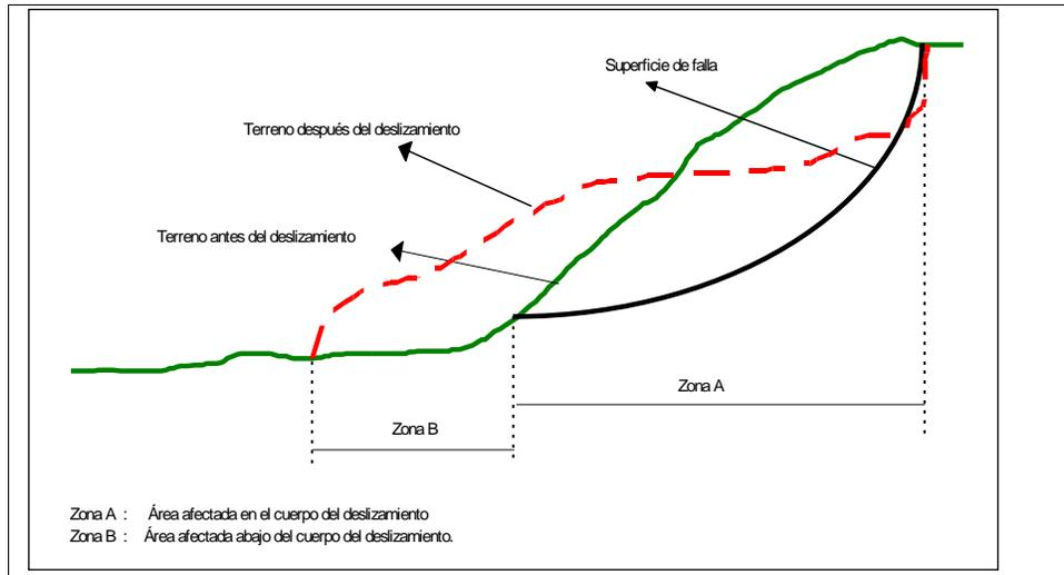
**Figura 6. Esquema de deslizamiento**
