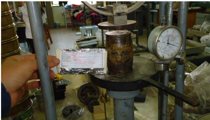
Fotografía 14. Muestra fallada en el ensayo de compresión no confinada.
