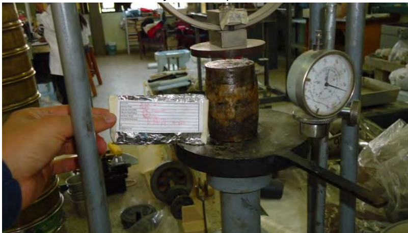
Fotografía 15. Muestra fallada en el ensayo de compresión no confinada.
