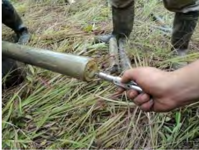
Fotografía 14. Prueba de Penetrometro de Bolsillo
