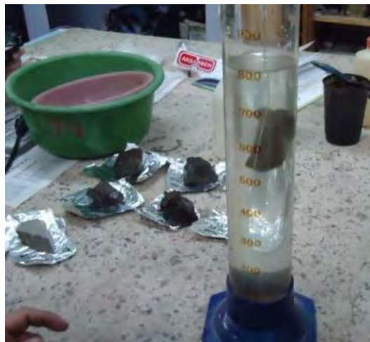
Fotografía 21. Medición de volumen de la muestra para establecer propiedades físicas de la roca.
