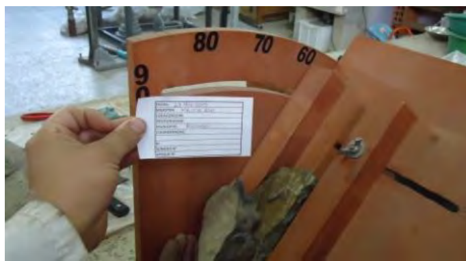
Fotografía 24. Ensayo de Tilt Test
