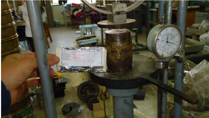
Fotografía 22. Muestra fallada en el ensayo de compresión no confinada.
