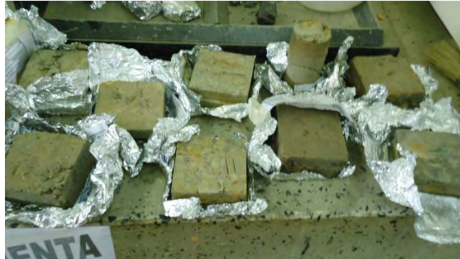
Fotografía 23. Muestras a las que se les realizo la prueba de corte directo.
