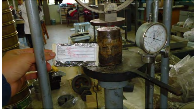
Fotografía 23. Muestra fallada en el ensayo de compresión no confinada.
