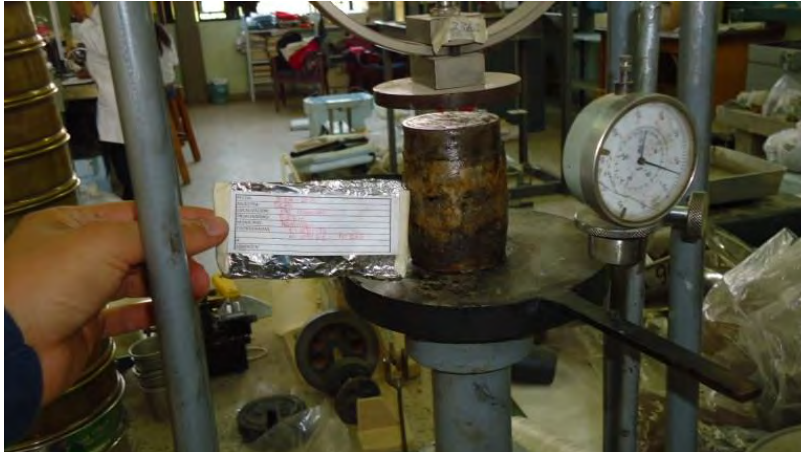
Fotografía 20. Muestra fallada en el ensayo de compresión no confinada.
