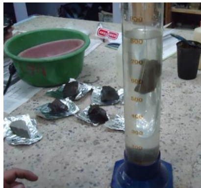
Fotografía 23. Medición de volumen de la muestra para establecer propiedades físicas de la roca
