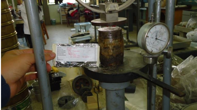
Fotografía 24. Muestra fallada en el ensayo de compresión no confinada.
